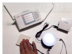
出力ケーブルに呼び出しブザー等を接続すれば同時に利用できます(「ブザーライトプラス」のみ)
